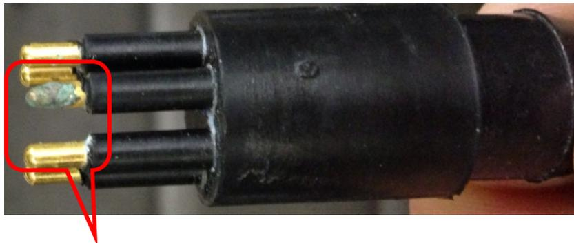
**Exemple de corrosion dû à un manque d'entretien et de graisse**
