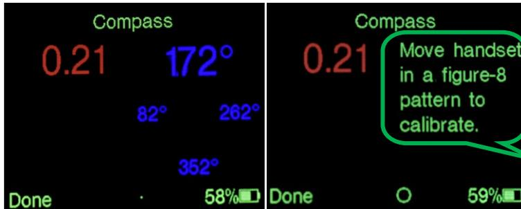
Le compas requiert de lui-même la calibration si nécessaire. Il suffit de décrire une figure en forme de 8 avec Handset **APECS 4™** en le tenant devant soi.
