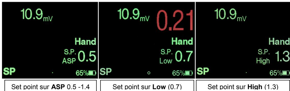
**ASP** (par exemple 1.2 bar) est normalement activé vers 6m après le Bubble Check. **ASP** va s'assurer que la PO<sub>2</sub> ne soit jamais supérieure à la valeur choisie, en tout point de la descente.
