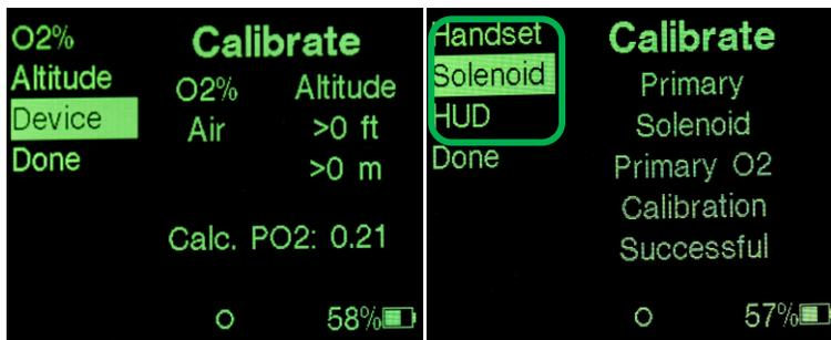
Il presse le bouton **Action / Confirm** lorsque **Device** est en surbrillance, et déroule ainsi la liste des modules physiquement connectés au réseau Primaire
