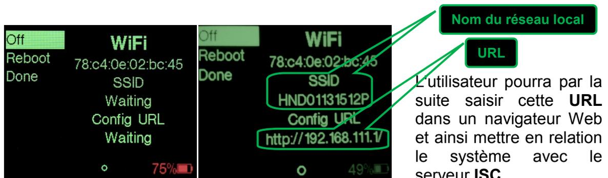
On peut former le Point d'Accès avec un SmartPhone, un Laptop, un Desktop ou tout appareil compatible Wi-Fi et le connecter grâce au **SSID** de l'**APECS 4™**.
